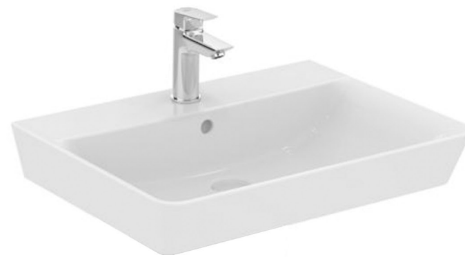
Umyvadlo keramické z jemné žárohlíny k osazení na nábytek, 550 x 460 x 100, provedení bílé, 1 otvor pro baterii pr.35 mm, přepadový otvor
