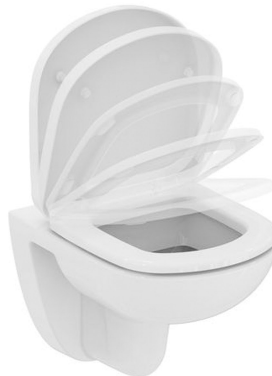
Keramický závěsný klozet zkrácený 480 x 370, ze slinutého keramického střepu (VC).EN 997. Hluboké splachování. Pro podomítkovou nádržku se splachovací kapacitou od 4,5 l. Instalace: s podomítkovým modulem do zdi nebo do sádkartonové přičky. Klozetové sedátko zkrácené sklápění soft close
