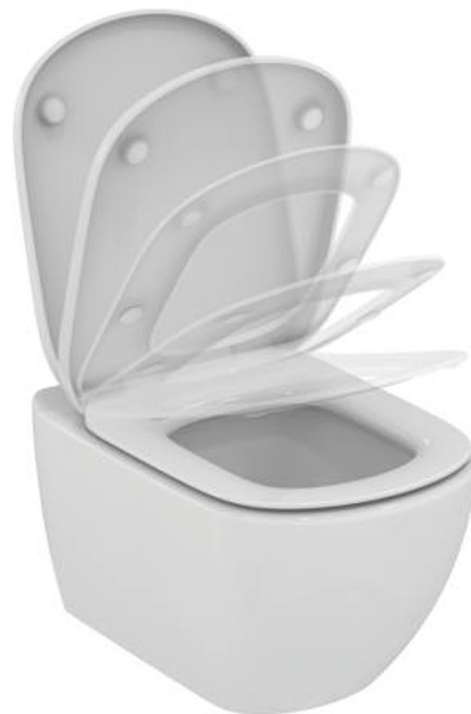
Keramický závěsný klozet 535 x 365 se systémem RIMLESS (bez splachovacího kruhu) se skrytým upevněním, ze slinutého keramického střepu (VC).EN 997. Hluboké splachování. Pro podomítkovou nádržku se splachovací kapacitou od 4,5 l. Instalace: s podomítkovým modulem do zdi nebo do sádkartonové přičky. Klozetové sedátko ultra ploché sklápění soft close
