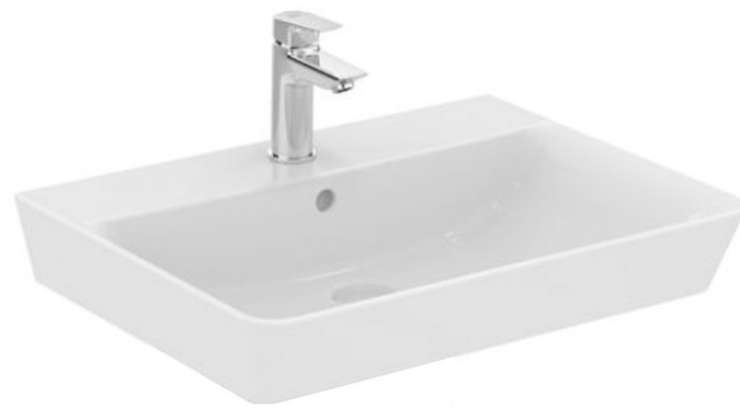
Umyvadlo keramické z jemné žárohlíny k osazení na nábytek, 500 x 450 x 100, provedení bílé, 1 otvor pro baterii pr.35 mm, přepadový otvor
