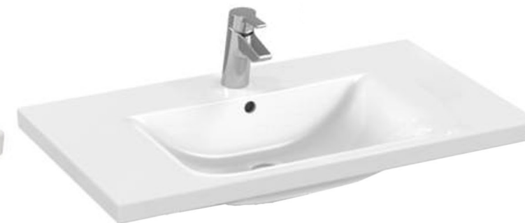
Umyvadlo keramické z jemné žárohlíny k osazení na nábytek, 850 x 490 x 145, provedení bílé, 1 otvor pro baterii pr.35 mm, přepadový otvor
