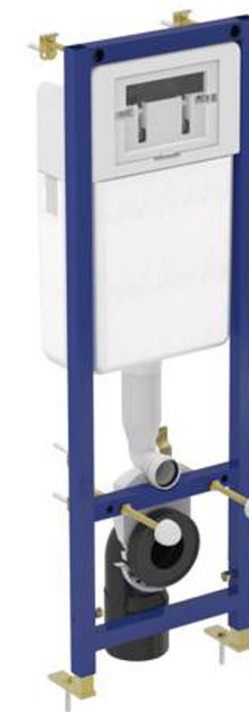
Podomítkový modul pro závěsné klozety - kotvení do keramické pevné stěny, nebo SDK, dvojčinné splachování 3/6 l, nastavitelný rám: hloubka: 135–245 mm výška: 100–1300 mm šířka: 350 mm, s úpravou zabraňující kondenzaci vody, stop rohový ventil G1/2", vrchní přívod vody, včetně splachovací trubky, včetně odpadní trubky a šroubů k upevnění WC
